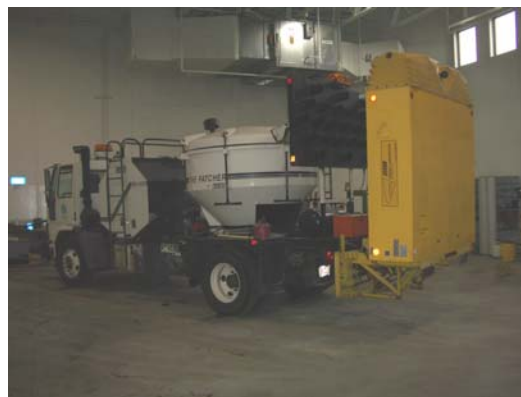
Énmannsbetjent utstyr for asfaltlapping
