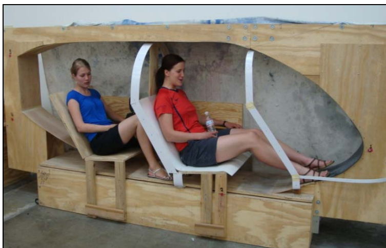
Figur 2: Testing av indre størrelse i SkyTran-vognen (foto: Erik Holth)
