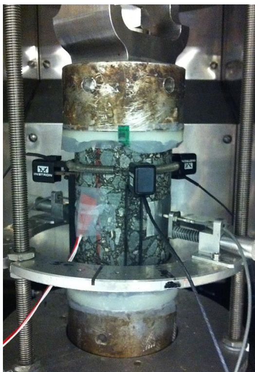
Figur 3: Exempel på mätuppställning för konventionella cykliska belastningar. Fotot är taget vid ENTPE, University of Lyon
